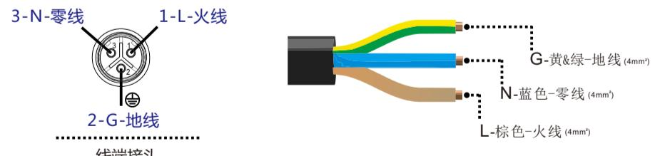
注：您可以选购专业定制的带有T型连接器的交流总线，用此交流总线作为每条支路的交流总线，手拉手连接后构成模块化的微逆变支干线布线系统。
